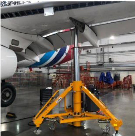
J-POD35 ，窄体飞机机身千斤顶，也有单级或多级版本，适应复杂工况条件。
