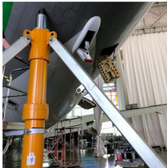
J-POD55 ，宽体飞机机身千斤顶，也有单级或多级版本，适应复杂工况条件。
