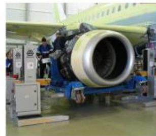
J-SEL1105 ，目前运行于俄罗斯苏霍伊飞机制造工厂生产线，1米举升高度，荷载5吨。
